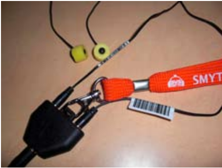
写真6 測定用カナル型マイクロフォン
